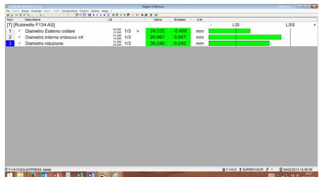
Esempio di interfaccia operatore senza grafici ma con barre estese.
