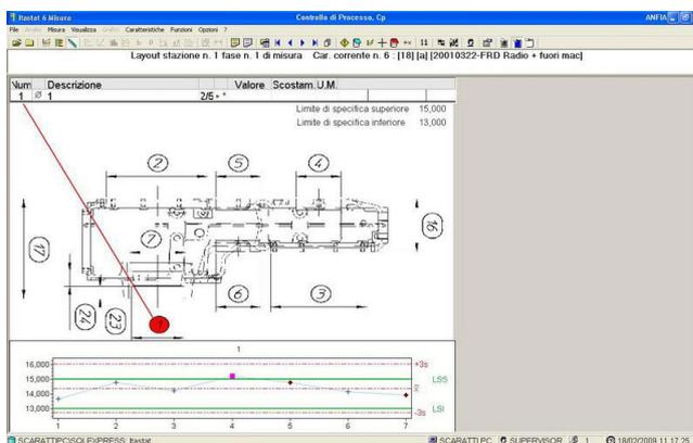
Esempi di interfaccia operatore con opzione Lay Out Designer, che permette di personalizzare la visualizzazione per ciascuna fase del ciclo di controllo.
