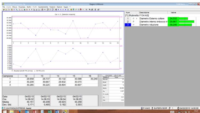
Esempio di interfaccia operatore con carte di controllo per caratteristica, e barre colorate per visualizzare puntualmente ciascuna misura effettuata.
