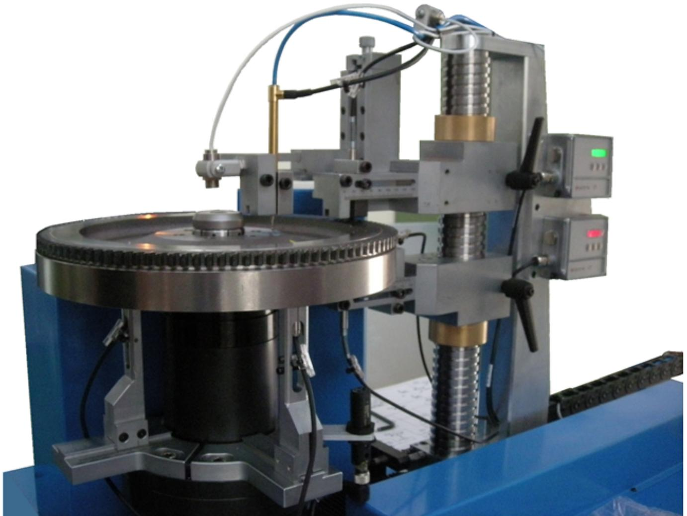
Nell'immagine si nota il sensore laser completamente racchiuso da una protezione dotata di saracinesca automatica, ad azionamento pneumatico, che garantisce il rispetto degli standard di sicurezza richiesti.
