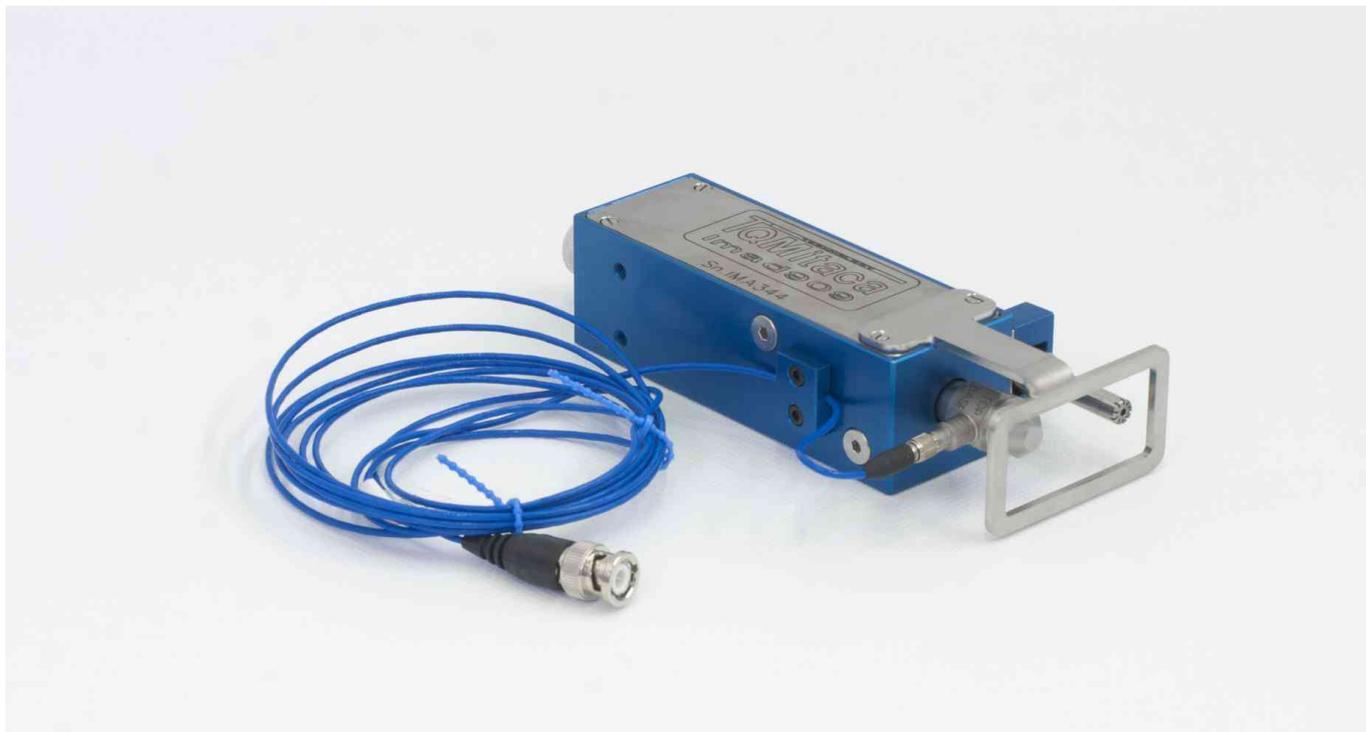
Il microfono è integrato, per semplificare le operazioni di riattrezzamento per cambio tipo. La forza di impatto e importanti parametri sono totalmente configurabili dal sw Itasonic 2010<sup>®</sup>. Il martello automatico garantisce la massima ripetibilità dell'impatto, fondamentale per una corretta analisi dello spettro sonico.
