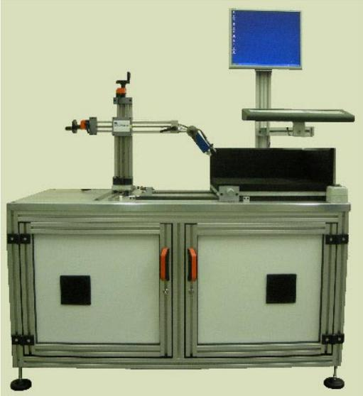
Banco semiautomatico per controllo di pinze, staffe, supporti, backplates, etc... con innovativo sistema di configurazione che garantisce estrema ripetibilità delle condizioni di prova: la soluzione ideale per testare oggetti con forma complessa per i quali è necessario impattare il pezzo secondo quanto previsto dai capitolati. Carico e scarico manuale.
