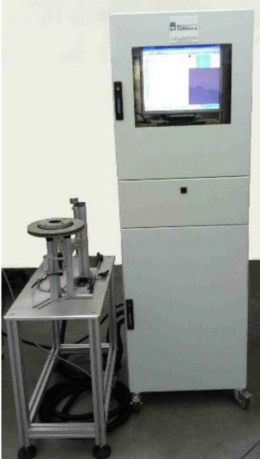
Postazione automatica per controllo dischi e tamburi freno, con meccanica registrabile ed elettronica collocata in armadio elettrico. Carico e scarico con robot e ciclo di misura automatico.
