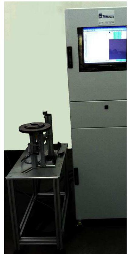
Sono disponibili anche stazioni di controllo FRF integrate direttamente nel calibro **Itageo 6<sup>®</sup>**: è presente un elevatore che ha la funzione di svincolare il disco dal calibro per il controllo frequenze, e nel contempo permette di evitare il carico diretto del disco sul mandrino di precisione da parte del robot di carico/scarico
