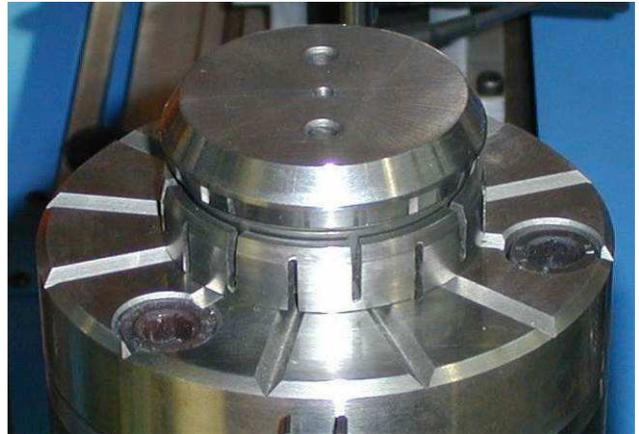
La soluzione adottata simula la condizione di montaggio, e la misura eseguita è corretta e indipendente dagli errori di forma del foro.
